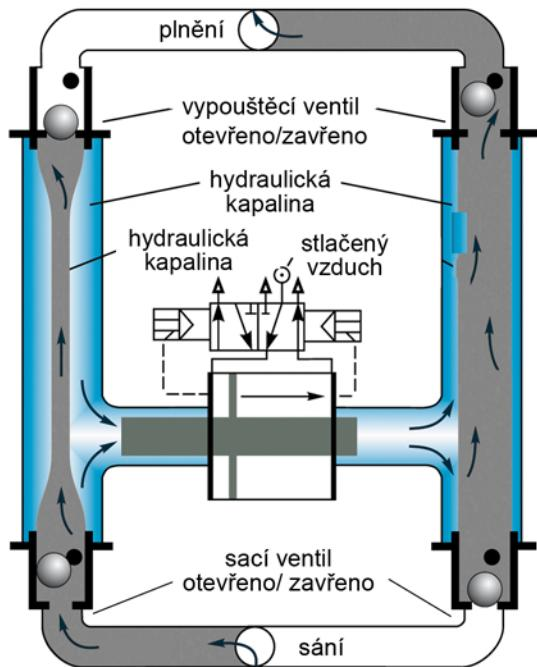
**Dvojitá ochrana:** V případě poškození hadice, čerpadlo pokračuje dál v práci jako jednoduché pístové čerpadlo. Díky tomu může být opraveno až po několika dnech. Poškození hadice lze detektovat volitelnou senzorovou jednotkou. Hydraulická kapalina je založena na bázi biologického oleje a nebo glycerinu, obě látky jsou pro povrchové vody neutrální a netoxické.
